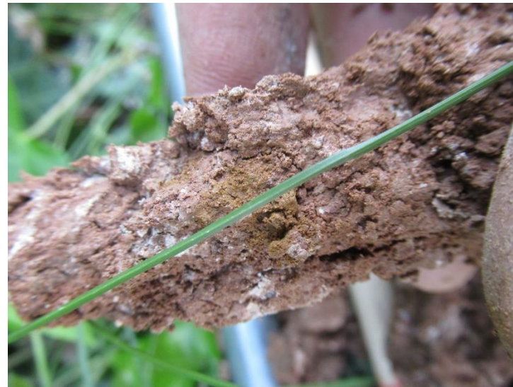
Sondage n°29 réalisé au droit d'un fossé, résultat positif et traits rédoxiques dans un fragment de la carotte pédologique
